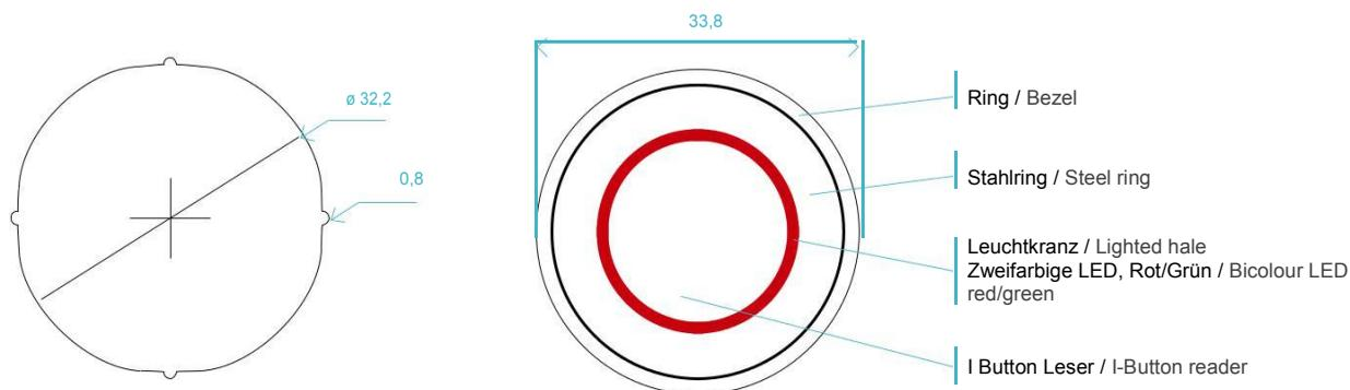
Elektronischer Schlüsselkontakt, zur Befähigung der Verwendung des Aufzugs, nur durch befugte Personen, in Mehrfamilienhäusern oder professionellen Bereichen, in denen eine besondere Zugangsüberwachung notwendig ist. / Electronic Key-switch to enable the lift use only to authorized passengers, in apartment buildings or professional offices where a special access control is required.
